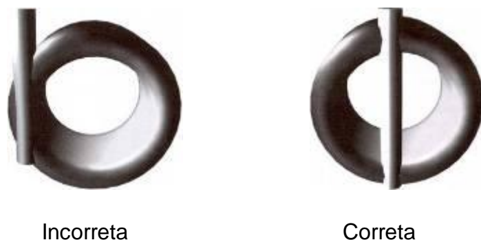
Fig. 1. Colocação do pino de Schanz.
